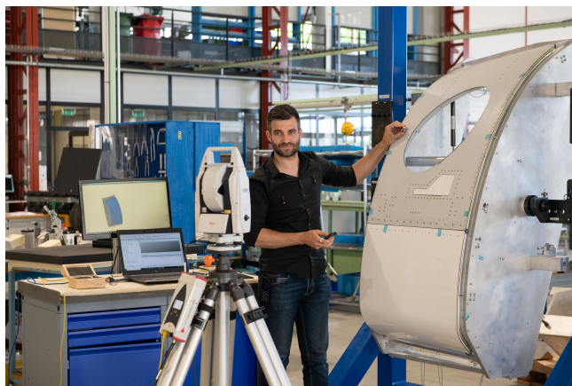
Structure de la porte en composite de l'avion ALICE dans l'usine POTÉZ AÉRONAUTIQUE
